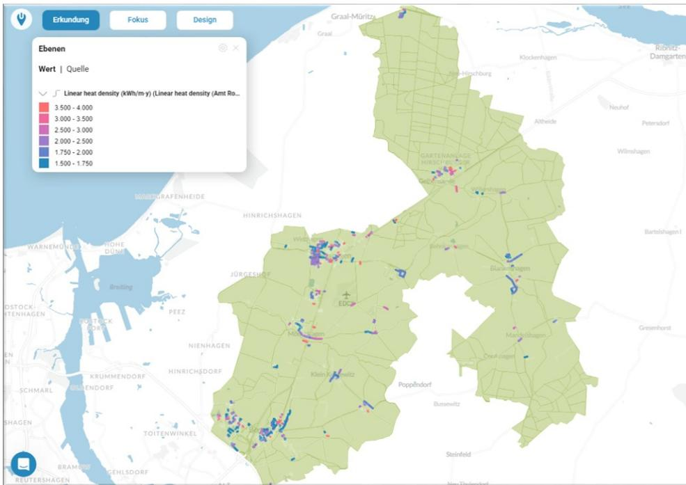
Abbildung 1: Amtsbereich mit Wärmelinien – je roter, desto höher ist der Wärmebedarf im Straßenabschnitt (Quelle: LGMV/urbio)
